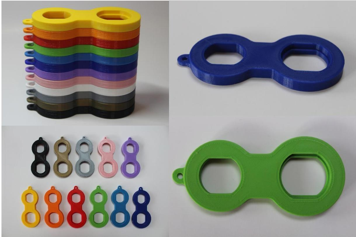
Dieser 3D-gedruckte Perlatorschlüssel eignet sich zum Öffnen/Montieren von Perlatoren (z.B. an Wasserhähnen) mit der Schlüsselweite (in mm) 22, 24 und 28. Die allgemein gängigste Größe 22 ist am Schlüssel von zwei Seiten zu nutzen. Der Kunststoff PLA (Polylactid) ist robust, aber doch weich genug um Schäden (z.B. Kratzer) am Perlator zu vermeiden. Der sehr robuste Kunststoff ist aus nachwachsenden Rohstoffen hergestellt, ökologisch unbedenklich und biologisch abbaubar!
